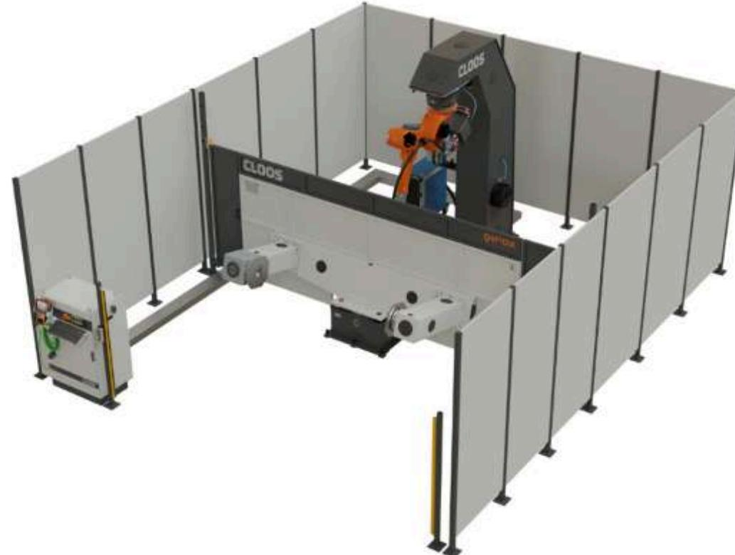
Le système compact haute performance **QR-CS-3** est parfaitement adapté aux composants de taille moyenne jusqu'à un poids de 20 kN (5 kN pour U) par station, pouvant être soudés avec une rotation verticale de la pièce. Le système compact QR-CS-3 dispose d'une table tournante à deux stations, le changement de station s'effectuant par une rotation verticale. Les outils de serrage pour le maintien des composants peuvent être facilement montés entre les plateaux du positionneur.
