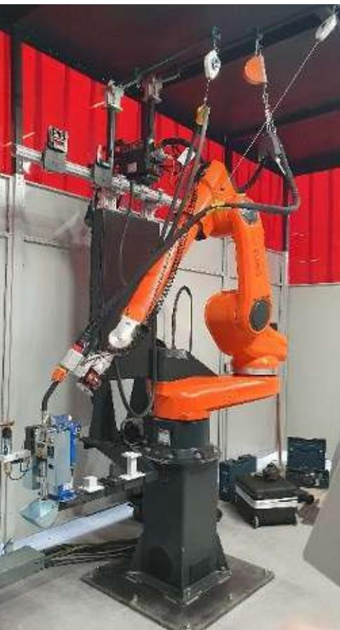
Le système compact haute performance QR-CS-4 est parfaitement adapté aux composants de petite à moyenne taille jusqu'à un poids de 10 kN (5 kN pour U) par station, pouvant être soudés avec une rotation verticale de la pièce. Le système compact QR-CS-4 dispose d'une table tournante à deux stations, le changement de station s'effectuant par un mouvement rotatif horizontal. Les outils de serrage pour le maintien des composants peuvent être facilement montés entre les plateaux du positionneur.
