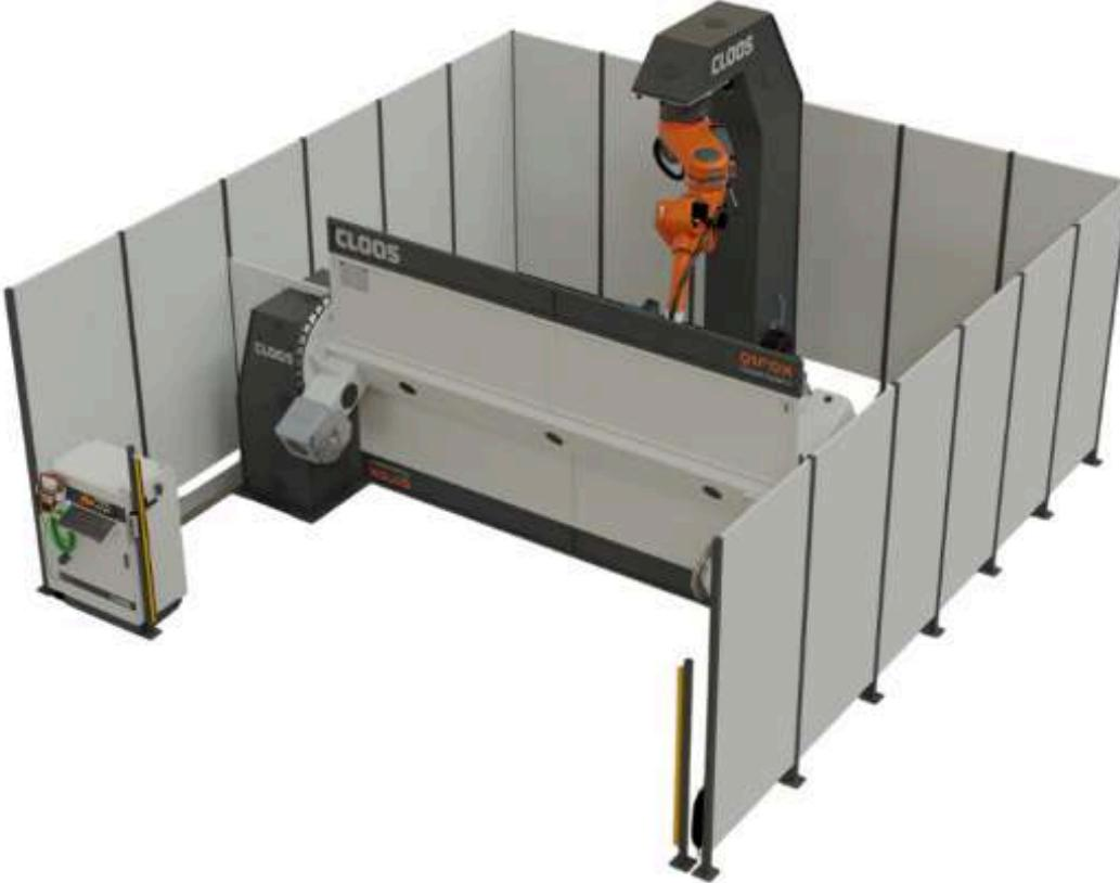
Le système compact haute performance QR-CS-2 est parfaitement adapté aux composants de taille moyenne jusqu'à un poids de 20 kN par station, pouvant être soudés avec une rotation verticale de la pièce. Le système compact QR-CS-2 dispose d'une table tournante à deux stations, le changement de station s'effectuant par une rotation verticale. Les outils de serrage pour le maintien des composants peuvent être facilement montés entre les plateaux du positionneur.
