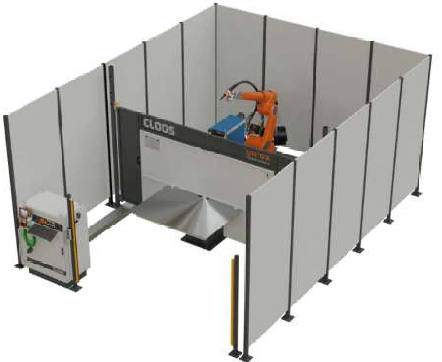
Le système compact haute performance **QR-CS-1** est parfaitement adapté aux composants de taille moyenne jusqu'à un poids de 10 kN, pouvant être soudés sans déplacement de la pièce. Le système compact QR-CS-1 est équipé d'une table tournante à deux stations, le changement de station s'effectuant par un mouvement rotatif horizontal. Les outils de serrage destinés au maintien des composants peuvent être facilement montés sur la surface de serrage du positionneur.
